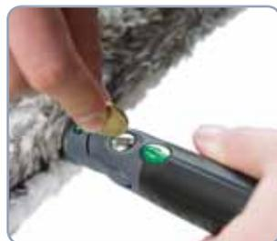
**Impostazione della tensione:** agendo semplicemente sulla vite d'acciaio, regolabile usando una moneta, è possibile aumentare o diminuire la tensione.
